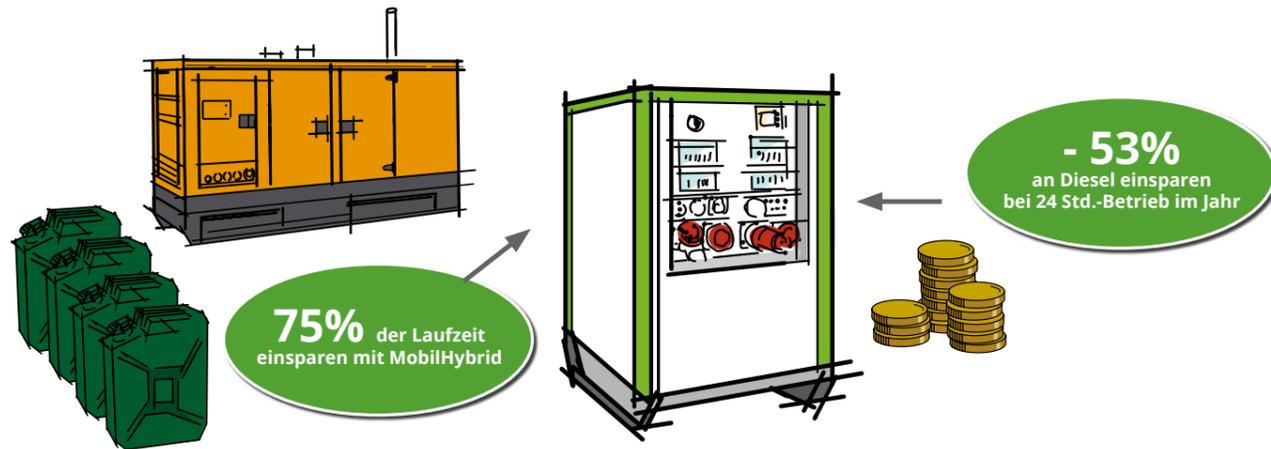
Meist ist die benötigte Energiemenge gar nicht besonders hoch oder unterliegt stark schwankenden Stromverbräuchen. Dieselgeneratoren haben bei geringer Last, also wenigen oder schwachen Verbrauchern, einen extrem schlechten Wirkungsgrad, was den Treibstoffverbrauch unverhältnismäßig in die Höhe treibt.
